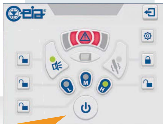
Световая индикация, пропорциональная объёму обнаруженного металла (малый, средний, большой)
